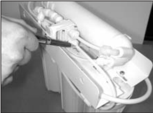
Figure 9 - Débranchez le tube de sortie du préfiltre à charbon de la soupape d'arrêt
